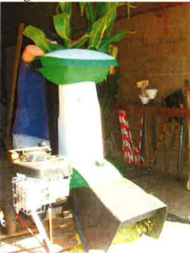
Imagen 6. Procesado de planta: triturado
